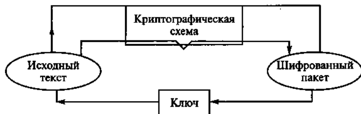
Рис. 6.5. Схема процесса дешифрования
